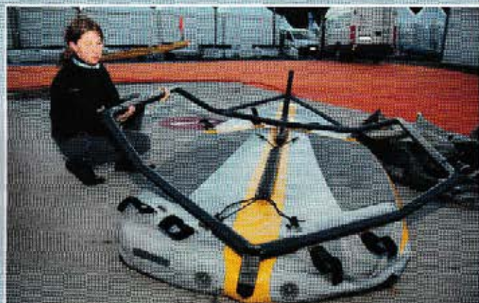
▲ La structure n'est liée au flotteur que par des sangles à Velcro, la désolidariser prend quelques instants. On démonte ensuite les tubes.
