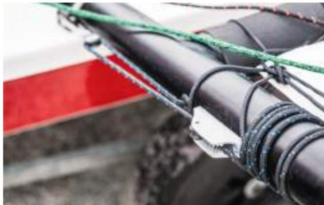
Die Schwimmer werden per Leinenspannung auf Zapfen am Schwertkasten gesichert und lassen sich schnell demontieren
