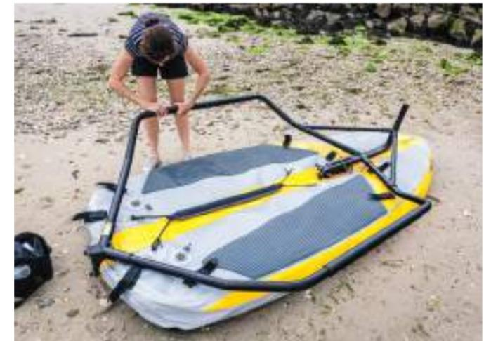
Rumpf aufpumpen, Rahmen zusammenstecken, aufriggen – die Tiwal ist in 20 Minuten einsatzbereit
